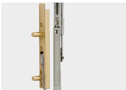
Safety Pin - der Sicherheitsstift sichert jedes Drehkippenfenster gegen die Möglichkeit, dass der Flügel durch falsche oder unsachgemäße Handhabung oder Missbrauch aus dem Rahmen fällt. Die auf der Scharnierseite platzierte Sicherung ist mit dem zentralen Drehkippenverschluss integriert. Sein federndes Stahlseil verhindert das Herausfallen des Fensterflügels aus dem Rahmen und beugt möglichen Unfällen wirksam vor.
