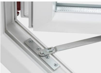
Stellt die Öffnungsweite des Fensterflügels an der gewünschten Position ein. Die Öffnungsbremse kann nur in der R-Version des Fensters verwendet werden, nicht aber bei einer niedrigen Schwelle und in der Version des Fensters mit höherer Einbruchschutzklasse RC und SECURITY.
