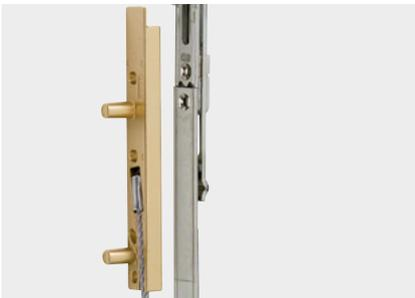
Dieser Beschlag ist für RU-Flügel mit rechteckiger Form, nur mit Oberflächenscharnieren, ohne Möglichkeit der Verwendung von Bremsen, Drehbegrenzern und niedriger Schwelle bestimmt. Die auf der Scharnierseite platzierte Sicherung ist mit dem zentralen Drehkippsverschluss integriert. Sein federndes Stahlseil verhindert das Herausfallen des Fensterflügels aus dem Rahmen und beugt möglichen Unfällen wirksam vor.
