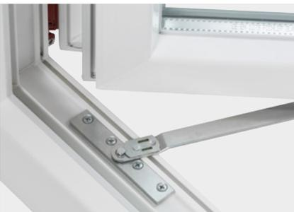
Stellt die Öffnungsweite des Fensterflügels an der gewünschten Position ein. Die Dreh Sperre kann nur in der R-Version des Fensters verwendet werden, nicht aber bei einer niedrigen Schwelle und in der Version des Fensters mit höherer Einbruchschutzklasse RC und SECURITY.
