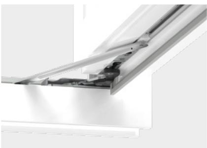
Er verhindert ein zu starkes Öffnen des Flügels und damit ein Anschlagen des Fensterflügels an der Wand. Der Drehbegrenzer kann sowohl bei aufliegenden als auch bei abgedeckten MultiPower-Scharnieren verwendet werden. Er kann nicht in Fenstern mit höherer Einbruchhemmungsklasse RC und SECURITY eingesetzt werden.
