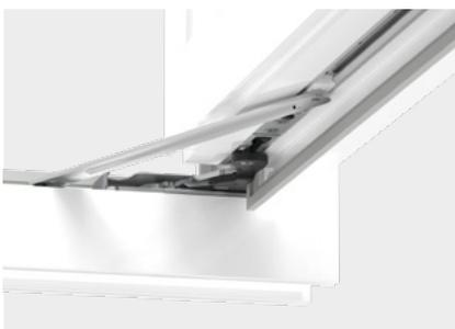
Er verhindert ein zu starkes Öffnen des Flügels und damit ein Anschlagen des Fensterflügels an der Wand. Der Drehbegrenzer kann sowohl bei aufliegenden als auch bei abgedeckten MultiPower-Scharnieren verwendet werden. Nie może być stosowany w wersji okien o podwyższonej klasie odporności na włamanie SECURITY. Er kann nicht in Fenstern mit höherer Einbruchhemmungsklasse RC und SECURITY eingesetzt werden.
