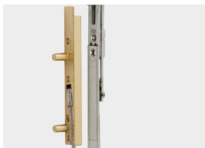
Safety Pin - der Sicherheitsstift sichert jedes Drehkippenfenster gegen die Möglichkeit, dass der Flügel durch falsche oder unsachgemäße Handhabung oder Missbrauch aus dem Rahmen fällt. Die auf der Scharnierseite platzierte Sicherung ist mit dem zentralen Drehkippsverschluss integriert. Sein federndes Stahlseil verhindert das Herausfallen des Fensterflügels aus dem Rahmen und beugt möglichen Unfällen wirksam vor.
